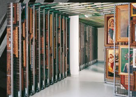
Waterpas gehangen schilderijwanden met geleiderails aan het plafond.
